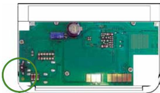
dip switch in ALTO per la protezione ANTIGELO 5°C
