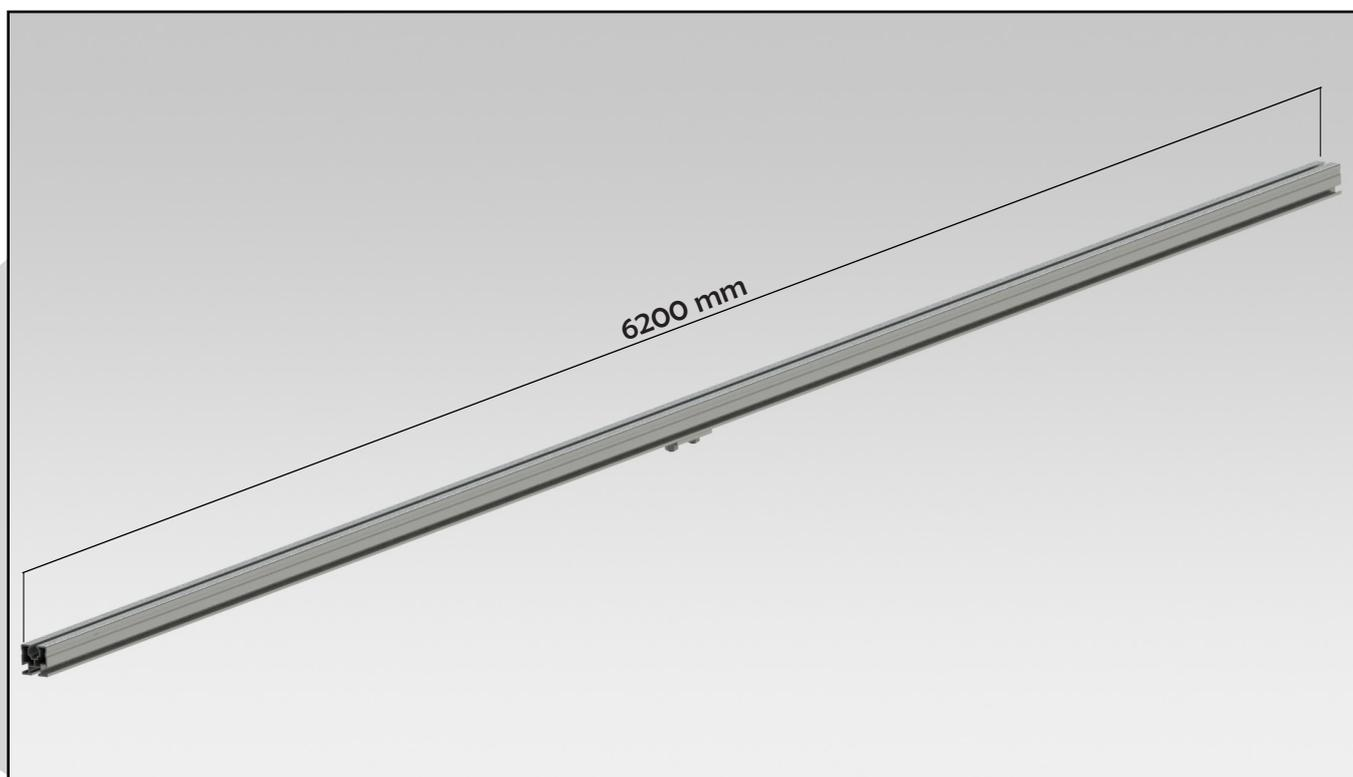
**4** Serrare longitudinalmente la barra alle staffe precedentemente fissate con l'apposita viteria di fissaggio inclusa.
