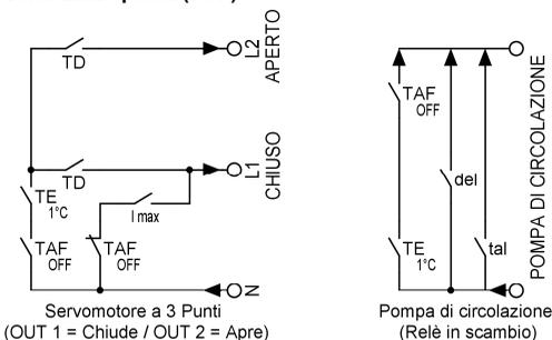
Logica di funzionamento in accordo con lo schema idraulico 'SCH\_2' (vedere pagina 7):
