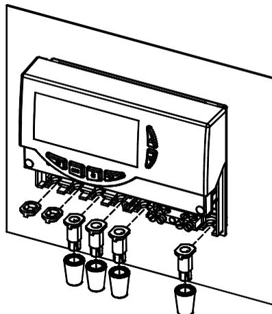
8. Eseguire i collegamenti elettrici, in accordo con lo schema idraulico scelto nel parametro installatore "P1 SCH".
