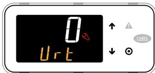
1. Alimentare il controllo e attendere che il display mostri il primo parametro Vrt (regolazione basata su valori pressione o temperatura);
