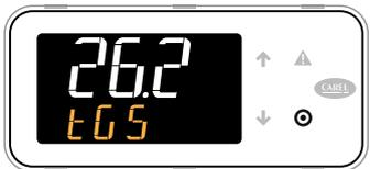
8. Premere DOWN: tGS indica la temperatura di aspirazione di linea 1
