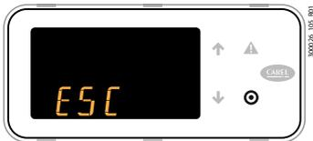
7. Premere PRG per 3 s oppure, in alternativa, a livello parametri selezionare ESC e premere PRG per tornare alle categorie di parametri
