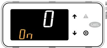
4. Premere PRG: compare il primo parametro: ON (Comando manuale pompa 1)
