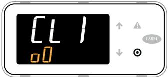
5. Premere DOWN: CL1 indica lo stato dei singoli compressori della linea 1: (⌋) per il compressore spento, (o) per il compressore parzializzato e (O) per il compressore acceso alla massima capacità
