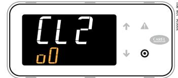
7. Premere DOWN: CL2 indica lo stato dei singoli compressori della linea 2: (⌋) per il compressore spento, (o) per il compressore parzializzato e (O) per il compressore acceso alla massima capacità
