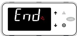
7. premere PRG per terminare la procedura di prima configurazione (wizard); una volta configurati tutti i parametri (nessuna icona "assistenza" visualizzata), premendo PRG si termina la procedura di prima configurazione (wizard);
