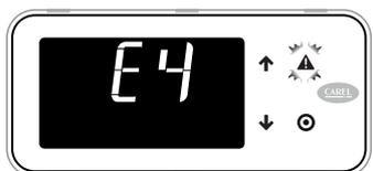
2. Premendo il tasto Alarm si tacita il buzzer e si visualizza il codice dell'allarme; premendo i tasti UP/DOWN si scorre la lista di eventuali altri allarmi
