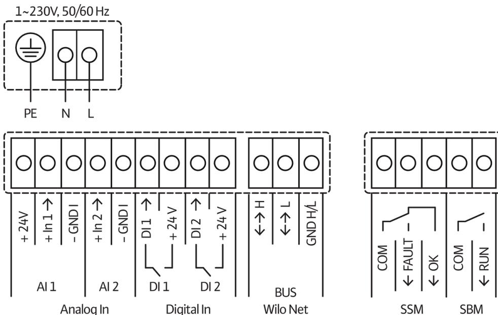
SSM: segnalazione cumulativa di blocco (contatto normalmente chiuso secondo VDI 3814, carico massimo 1 A, 250 V ~)
