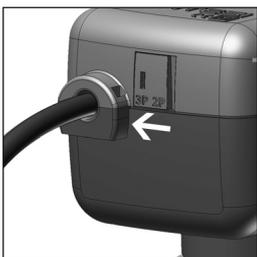
**NOTA:** Il collegamento del cavo di alimentazione deve avvenire internamente ad una scatola di derivazione che garantisca una protezione IP54 o superiore
