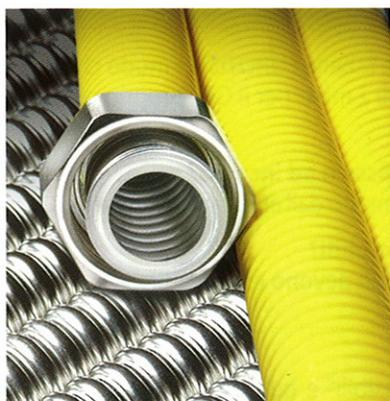
I sistemi di tubazioni CSST (Corrugated Stainless Steel Tubing) di EUROTIS ("EUROWATER" per impianti termo-idro-sanitari, e "EUROGW/EUROGAS" per impianti gas, "TWIN-SOLAR-SET" e "MONO&DUAL-SUN-SET" per impianti termici solari) sono basati sull'utilizzo di tubi corrugati formabili in **acciaio inossidabile austenitico AISI 304** (designazione: 1.4301 - X5CrNi18-10) e **AISI 316L** (designazione: 1.4404 - X2CrNiMo17-12-2) conformi alla norma EN 10028-7 che conferisce al prodotto:
