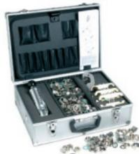
L'attrezzo automatico di flangiatura "BLACK" (codice A06-0001-1957) è raccomandato agli installatori che utilizzano frequentemente i tubi corrugati CSST, anche di tutte le dimensioni dal DN 10 (3/8") al DN 25 (1 1/4"), per impianti acqua, solare e gas. Il Kit "BLACK" per la flangiatura automatica dei tubi CSST è disponibile in valigetta di alluminio con manuale di istruzioni e:
