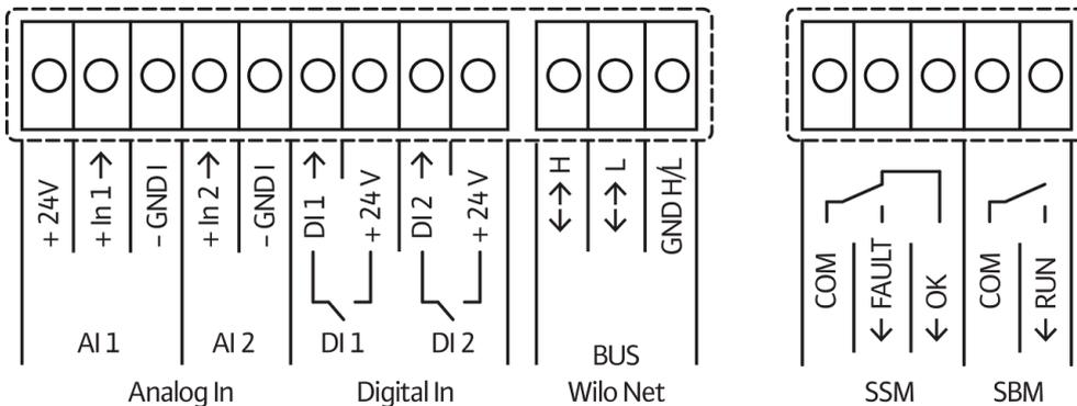
SSM: segnalazione cumulativa di blocco (contatto normalmente chiuso secondo VDI 3814, carico massimo 1 A, 250 V ~)
