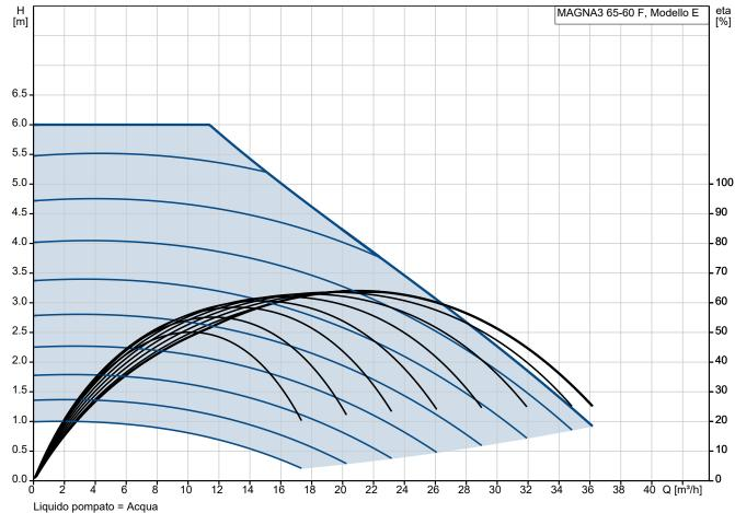
Temperatura del liquido durante l'esercizio = 60 °C Densità = 983.2 kg/m³
