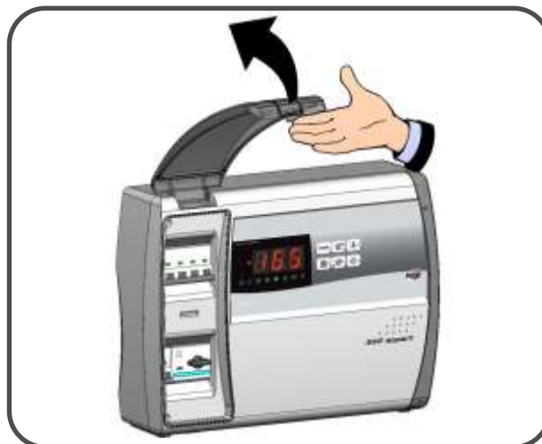
Fig. 1: Sollevare lo sportello trasparente di protezione del magnetotermico generale.
