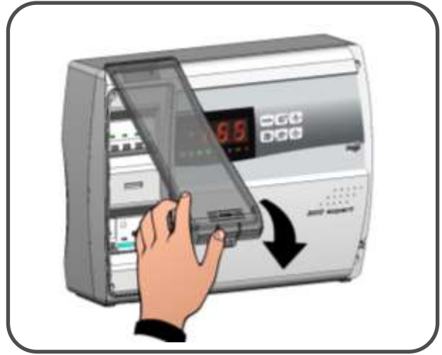
Fig. 4: Chiudere lo sportello trasparente di protezione del magnetotermico generale.
