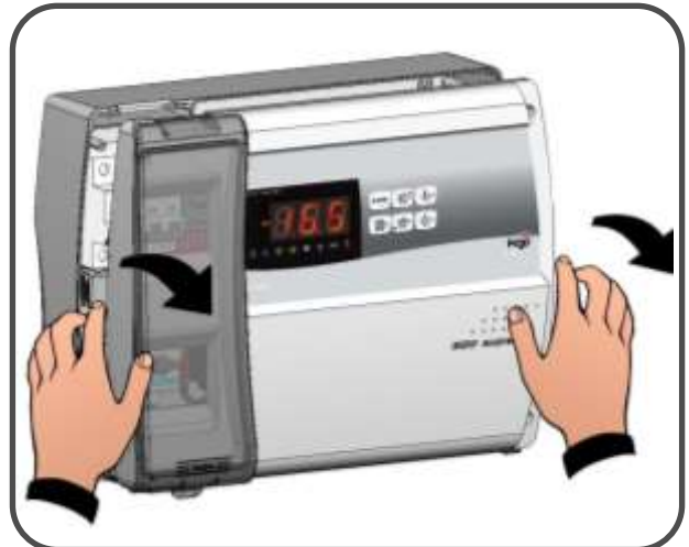
Fig. 5: Aprire il frontale del quadro sollevandolo e facendo scorrere le due cerniere fino a fine corsa.
