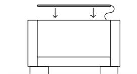
Dispositivo di sterilizzazione aria con lampada UVC.
