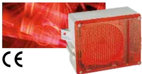
La **SIRELAMP** è un dispositivo di allarme ottico-acustico con tonalità selezionabile costituito da un circuito elettronico modulatore interfacciato ad un altoparlante piezoelettrico.
