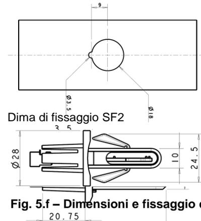
**Fig. 5.f – Dimensioni e fissaggio dei sensori SF2**
