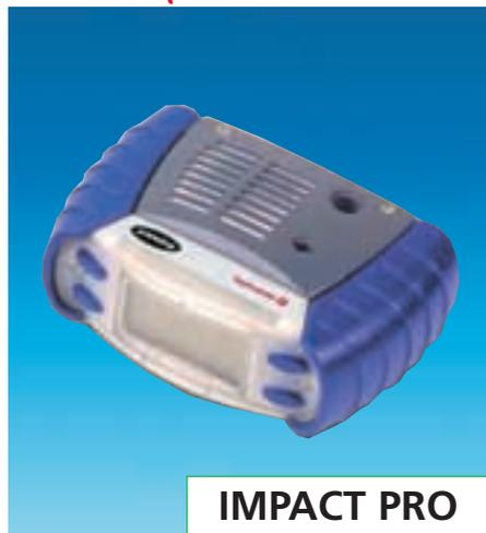
Il rivelatore portatile IMPACT PRO per la protezione individuale continua è uno strumento in grado di monitorare e visualizzare contemporaneamente fino a 4 gas, ossigeno, infiammabili e due tossici. L'IMPACT PRO può impiegare sia celle con sensori prearati a perdere sia intercambiabili, la cui sostituzione può essere effettuata in pochi minuti, semplificando la manutenzione, riducendo i tempi morti ed i costi.
