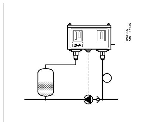
In un sistema booster che riceve acqua pressurizzata, il soffietto di destra è collegato
