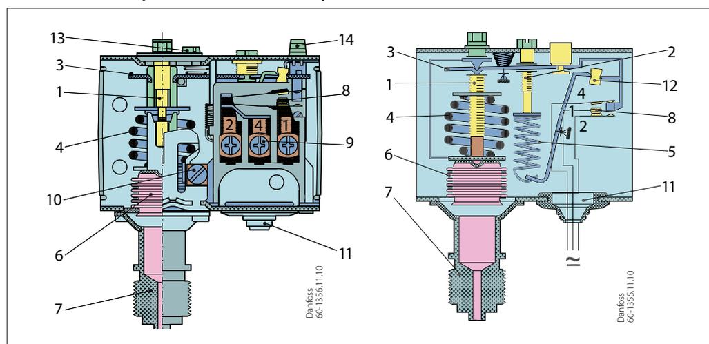
Il sistema di contatto nei pressostati KP ha una funzione di scatto. Ciò significa che il soffietto è attivo solo quando viene raggiunto il valore di inserimento o disinserimento. Il soffietto è collegato alla pressione dell'impianto controllato tramite il connettore (7).
