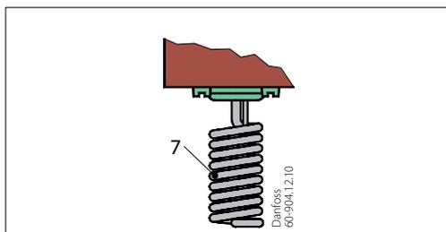
Il sistema di contatto nei termostati KP è dotato di una funzione a scatto. Ciò significa che il soffietto è attivo solo quando viene raggiunto il valore di inserimento o disinserimento.
