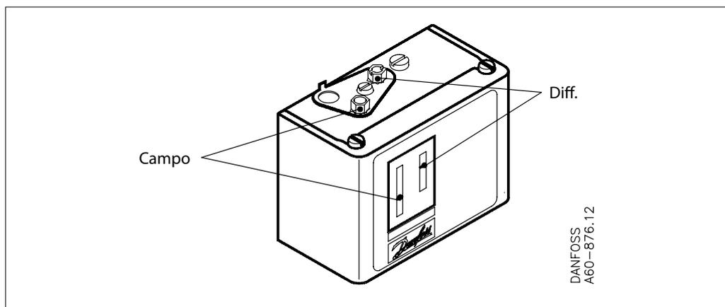
**Le pressioni di inserimento e disinserimento del sistema devono essere sempre controllate con manometri precisi.**
