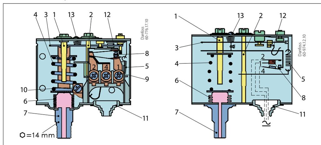
Schizzo chiave del pressostato KP, versione per caldaia
