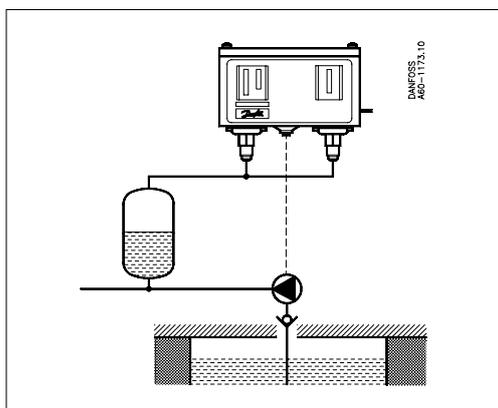
In un sistema idroforo in cui l'acqua viene pompata da un pozzo o da un serbatoio aperto, entrambi i soffiotti sono collegati, se possibile, a un'uscita di pressione sul lato aria della linea di pressione della pompa.
