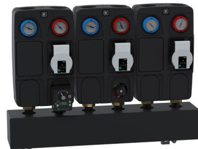
LK HydronicGroup è un gruppo pompa completo ideale per gli impianti di riscaldamento ad alimentazione diretta dalla caldaia o con valvola miscelatrice a tre vie. Comprende una pompa di ricircolo ad alta efficienza, isolamento, staffa per montaggio a parete e due valvole a sfera con termometro. Sul lato di ritorno c'è una valvola di ritegno integrata.
