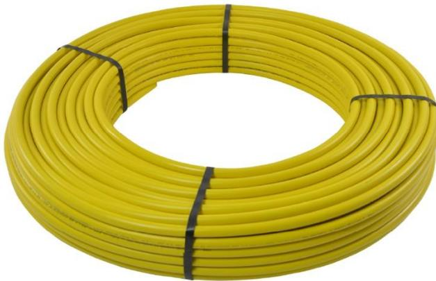
I tubi multistrato SESTA risultano fabbricati e testati in conformità alla norma Uni EN ISO 21003 classe 2/5. I tubi multistrato SESTA per il gas sono conformi alla norma UNI TS 11344 che prevede MOP 0,5 e temperature di esercizio – 20 °C + 70 °C.
