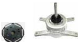
Ventilatori di scambio termico con l'esterno di tipo elicoidale con aspirazione sul lato posteriore e mandata orizzontale sul lato anteriore con portata d'aria di 55 mc/min .Tipologia di motore BLDC inverter con portata d'aria e basse rumorosità.
