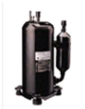
Sistema di erogazione della capacità composto da N°1 Compressore ermetico di tipologia Rotary BLDC inverter ad avviamento diretto,. controllo lineare della capacità con un campo di azione compreso tra il minimo del 10% fino ad un massimo del 130%.
