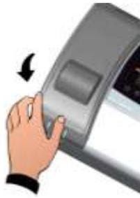
**Fig.4:** Abra el frontal de la caja levantándolo y haciendo correr las dos bisagras hasta final de carrera.
