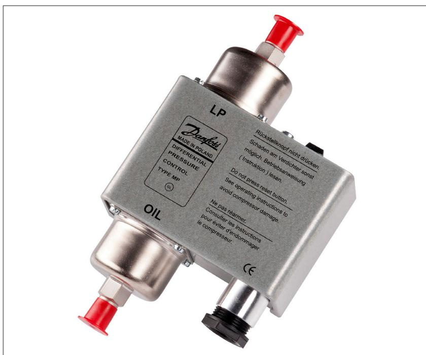
I pressostati differenziali olio MP 54 ed MP 55 sono pressostati di sicurezza usati per proteggere i compressori frigoriferi da pressioni troppo basse dell'olio di lubrificazione.
