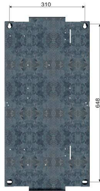
Fig. 2 Fori e dima di foratura per il montaggio a parete del Friwasta plus
