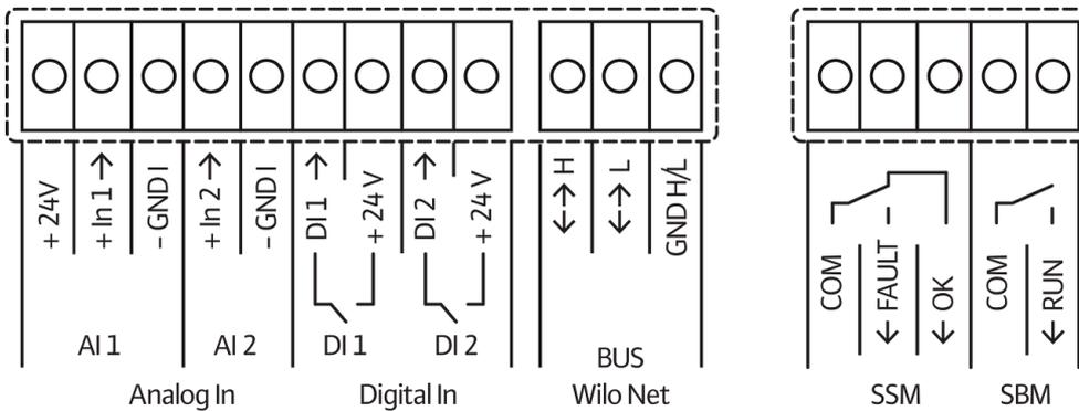
SSM: segnalazione cumulativa di blocco (contatto normalmente chiuso secondo VDI 3814, carico massimo 1 A, 250 V ~)
