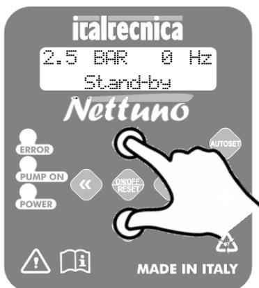
Per accedere a queste pagine, portare il dispositivo in Stand-by e premere per 5 secondi contemporaneamente i tasti "+" e "-". Una volta entrati nel menu nascosto, usare i tasti freccia "<<" e ">>" per scorrere le schermate e i tasti "+" e "-" per modificare i parametri. Per tornare alla schermata principale, premere il tasto centrale.
