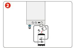
Caricare l'impianto, pressurizzare a 1 bar, accendere la caldaia e far circolare con funzione riscaldamento attiva a temperatura max 50 °C
