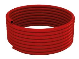
LetubazioniR996T-5inPEX-ba5strati(Polietilenereticolato con il metodo ai silani – grado di reticolazione > 65 %) possono essere utilizzate per la distribuzione dell'acqua negli impianti di riscaldamento e/o raffrescamento.
