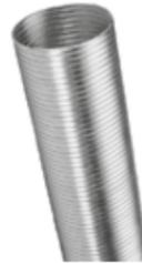
**Condotta THERMAFLEX N** Condotta flessibile estensibile in alluminio/poliestere con incorporata un'armatura elicoidale in filo di acciaio armonico. Temperatura di esercizio da -30°C a +130°C.
