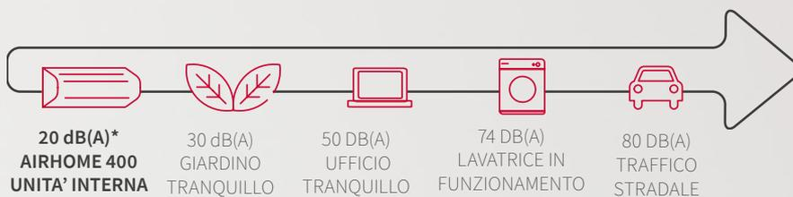
\*20 dB(A) di pressione sonora, alla velocità bassa del ventilatore, alla distanza di 1m dall'unità a campo libero, a seconda del modello di unità interna.
