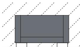
Pannello di copertura posteriore in caso di installazioni con il retro a vista.
