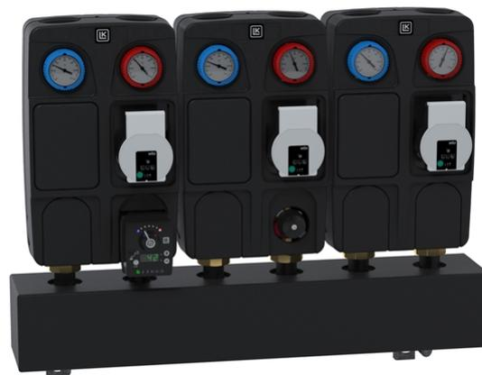
LK HydronicGroup è un gruppo pompa completo ideale per gli impianti di riscaldamento ad alimentazione diretta dalla caldaia o con valvola miscelatrice a tre vie. Comprende una pompa di ricircolo ad alta efficienza, isolamento, staffa per montaggio a parete e due valvole a sfera con termometro. Sul lato di ritorno c'è una valvola di ritegno integrata.
