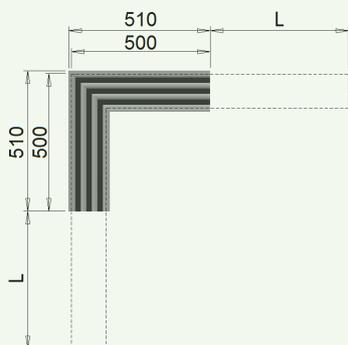
Elemento estetico di raccordo tra i due linee di diffusori lineari con angolo di 90° e lunghezza 500 mm per lato. Non ha funzionalità di ventilazione.
