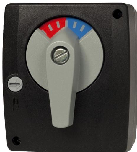
LK 950 sono una serie di attuatori per valvole. Secondo il modello l'attuatore può essere azionato da un controller con uscita a 3 punti SPDT o proporzionale 2 (0) - 10 V. L'attuatore è dotato di interruttori di fine corsa elettrici. L'angolo di rotazione è limitato elettricamente a 90°. Un finecorsa addizionale con angolo aggiustabile può essere ordinato come accessorio.
