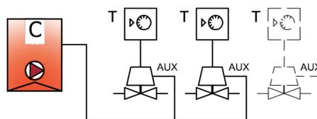
I contatti ausiliari di più servomotori possono essere collegati in parallelo alla caldaia. Il primo contatto che chiude aziona la caldaia. L'ultimo contatto che apre spegne la caldaia
