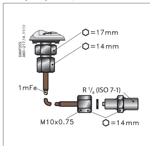
Il pressostato KP è dotato di una funzione di scatto e il soffietto si muove solo quando il valore di inserimento o disinserimento viene raggiunto. Il soffietto si collega al lato di bassa o alta pressione dell'impianto tramite l'attacco (10) o (11).
