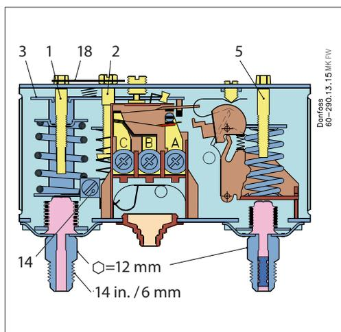
1. Vite settaggio bassa pressione (LP)
