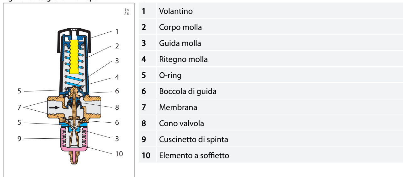
Figura 1: Design/Funzione per WVFX 10 – 25
