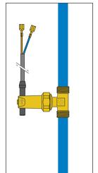
Il flussostato serie 315 può essere installato su tubazione verticale od orizzontale ma non in posizione capovolta. La parte superiore del flussostato, contenente il comando magnetico, è fissata rigidamente al corpo, pertanto non può essere rimossa.
