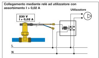
**N.B.:** Si raccomanda di prestare attenzione al valore di corrente assorbita dall'utilizzatore a cui si collega il flussostato. Qualora questo valore superi i **0,02 A**, occorre interporre un relè tra il flussostato e l'utilizzatore stesso per evitare di danneggiare i contatti del flussostato
