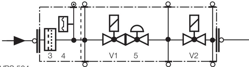
Possibile montaggio del controllo valvole VPS 504
