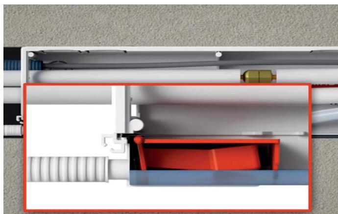
**IT** A scarico finito, il sistema FREESTOP si abbassa automaticamente chiudendo ermeticamente lo scarico grazie alla guarnizione o-ring in dotazione, a differenza delle predisposizioni con sifone che con l'evaporazione del liquido di condensa causato dal non utilizzo del condizionatore (es. dal mese di settembre al mese di maggio) favoriscono il passaggio dei cattivi odori vedi esempio.
