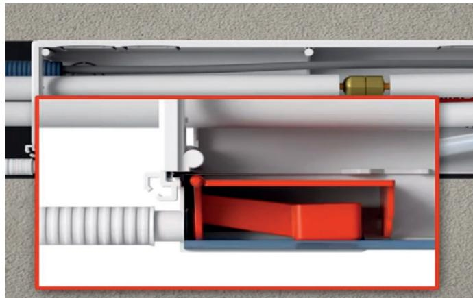
**IT** Con l'aumentare del livello dell'acqua di condensa, il galleggiante si alza automaticamente permettendo il deflusso del liquido.
